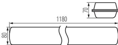
Kanlux MAH LED HI sind hermetische Leuchten, entworfen für anspruchsvollere Anwender. Sie zeichnen sich durch eine enorme Lichtausbeute von bis zu 150 lm/W aus. Es besteht die Möglichkeit, die Leuchten in einer Reihe zu verbinden, wodurch große Flächen beleuchtet werden können. Bei den MAH LED HI-Leuchten von Kanlux haben wir einen wellenförmigen Diffusor verwendet, der den Lichtstrom erhöht.
